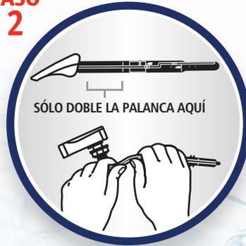
**Ajuste el brazo para adaptarse al tanque**
